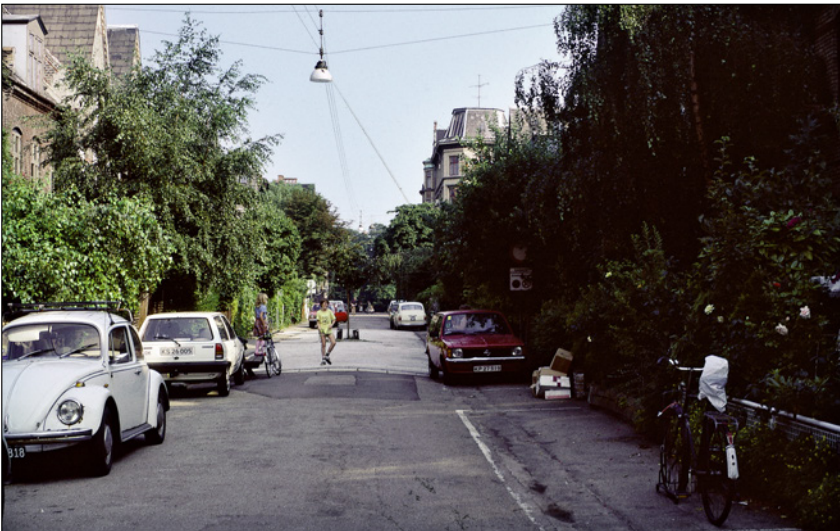
Calle residencial de coexistencia de tráfico en Copenhague. Velocidad limitada a 15 km/h y área central de juegos.
