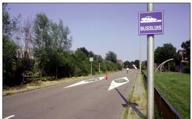
Barrera ("bus-sluis") que permite el paso de autobuses y vehículos de dos ruedas en Holanda.
