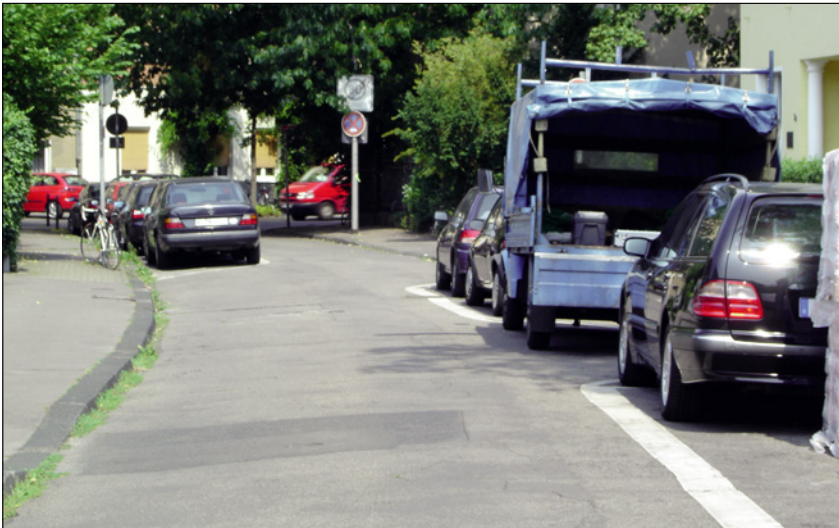
Zig-zag creado por disposición alternada del aparcamiento.
